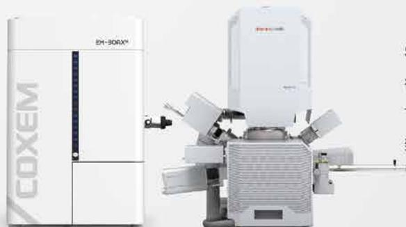
片剂中不同的原辅料由于其元素种类及含量的差异，可以通过扫描电镜-能谱仪（SEM-EDX）来检测到，进而可以确认片剂中混合以后的不同原辅料的分布情况及粒径，来判断片剂的混合均匀性；不同的原辅料由于其加工工艺条件有差异，在微观条件下可以通过分析原辅料颗粒的形貌来鉴别自制制剂中所用原辅料与参比制剂内的是否一致，欧波同在长期医药行业的应用开发中积累相当多的分析经验：
